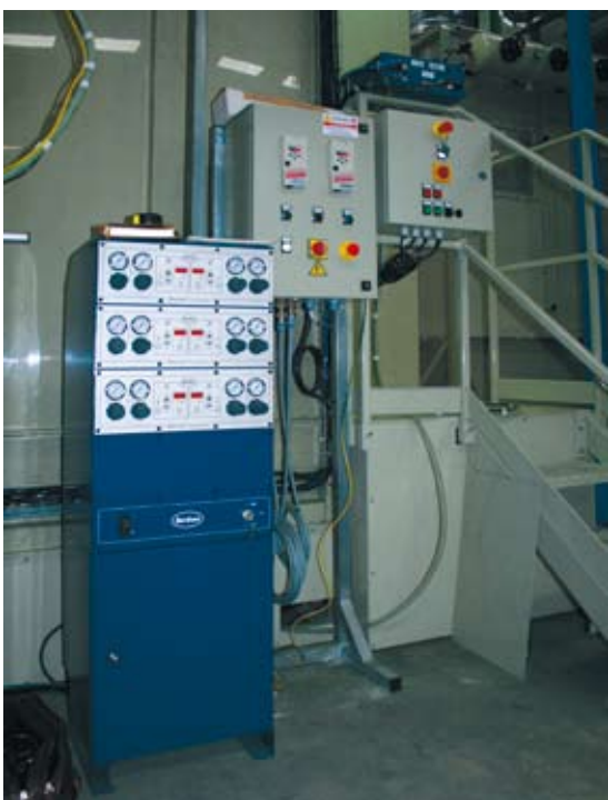
6 – La instrumentación de control del sistema de aplicación (Nordson).
