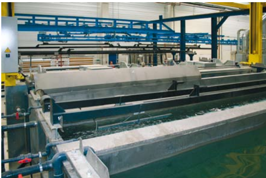
7 – Algumas cubas de pré-tratamento. A cuba de conversão nanotecnológica (orgânica) no rinse é o ocupado por dois suportes.
