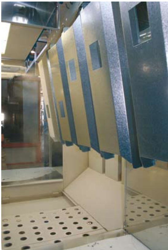
11 - El interior de la cabina durante la aplicación automática.
