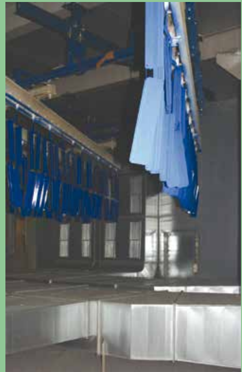
8 – Horno de polimerización y un detalle del interior. Los bastidores recorren un trayecto en forma de “Z”, lo que ha permitido mantener una estructura muy compacta y respetar las curvas de polimerización del polvo que se aplica.
