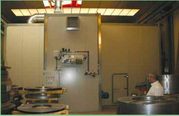
7 – Horno de secado del final de la fase de pre-tratamiento y dos detalles del interior.
