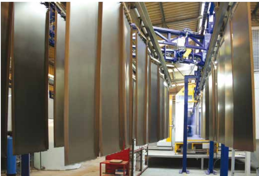
8 – Horno de polimerización y un detalle del interior. Los bastidores recorren un trayecto en forma de “Z”, lo que ha permitido mantener una estructura muy compacta y respetar las curvas de polimerización del polvo que se aplica.
